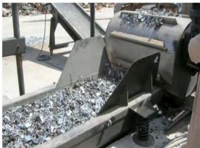
Classificação de materiais por rolos magnéticos
